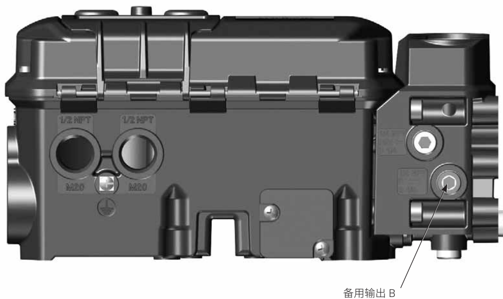
图 21. 底视图：气动端口，备用输出 B
