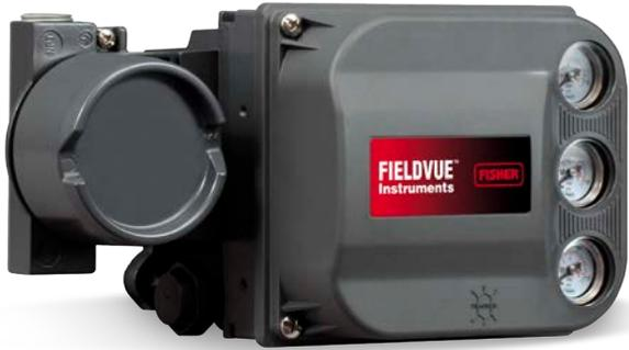
FIELDVUE DVC6200 数字式阀门控制器是一个 HART 通信仪表，用于将二线制 4-20mA 控制信号转换为气动输出以提供给执行机构。还为现有的模拟安装设备实现数字通信提供了简单方法。
