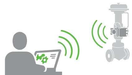
远程专家服务是 Plantweb™ 数字生态系统的一部分，可在全球单个或多个站点收集并汇总诊断数据。艾默生认证的分析师将会分析定位器数据，以寻找系统退化的模式，还会提供减少停机时间的建议措施。
