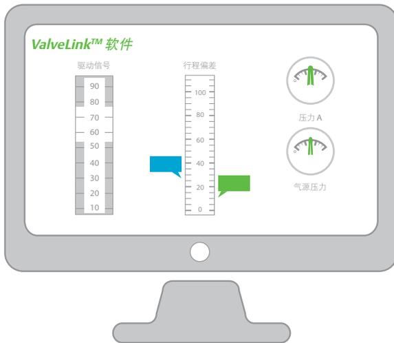
ValveLink™ 软件可以设置并校验阀门组件、监控状态和报警事件、移动阀门、执行阶跃测试、运行阀门特性曲线测试，还可以查看并保存之前的诊断测试。选件包括：ValveLink SOLO 单机版、ValveLink DTM 版、连接 AMS 设备管理器的 ValveLink SNAP-ON™ 版和 ValveLink PLUG-IN PRM 版。
